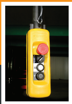
Hängetaster mit Wahlschalter zur Steuerung zweier Elektrokettenzüge
